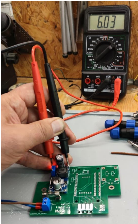
Obrázek 7: Otáčením šroubu na modrém více otáčkovém potenciometru nastavte na výstupu napětí 6 V
