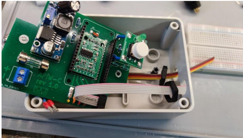
Obrázek 35: Před připojením konektorů nesmíte zapomenout na matice, které konektor zajistí na stěně krabičky
