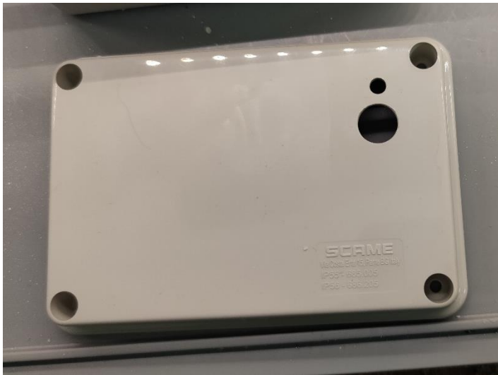
Obrázek 27: Víko krabičky po vyvrtání otvorů
