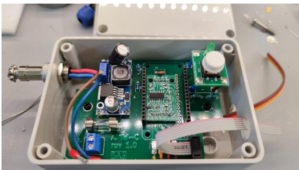
Obrázek 34: S destičkou je potom možné pohybovat tak, aby se tlačítko přesně trefilo do otvoru v horním krtu.
