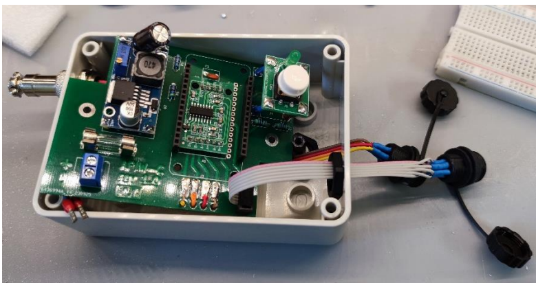
Obrázek 36: Připojené konektory před montáží do krabičky
