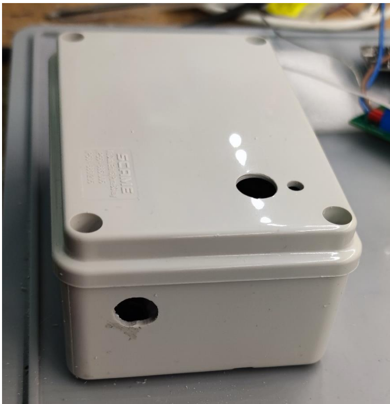
Obrázek 28: Výřez pro napájecí konektor
