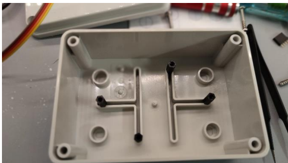
Obrázek 22: Krabička s připravenými montážními sloupky. Další dva sloupky slouží pouze pro podepření desky. Je nutné je umístit tak, aby na desce v tomto místě nebyla žádná připojená součástka.
