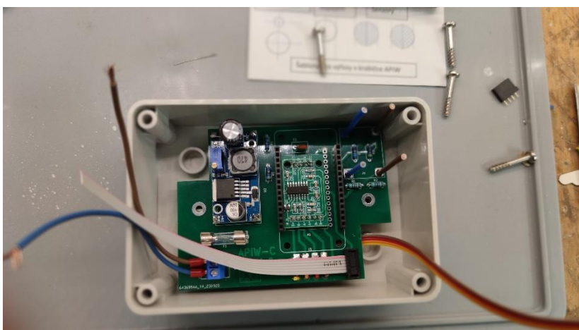
Obrázek 20: Kontrolní vložení osazené desky do krabičky
