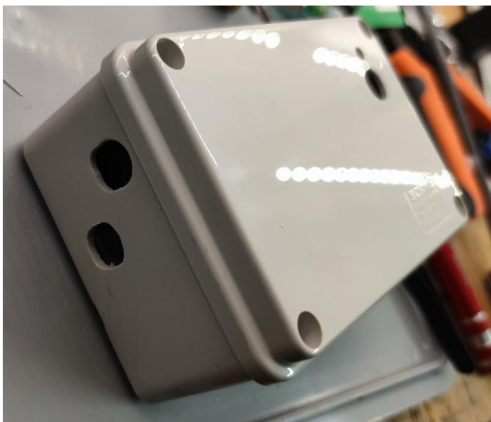
Obrázek 29: Výřezy pro teplotní a váhový senzor
